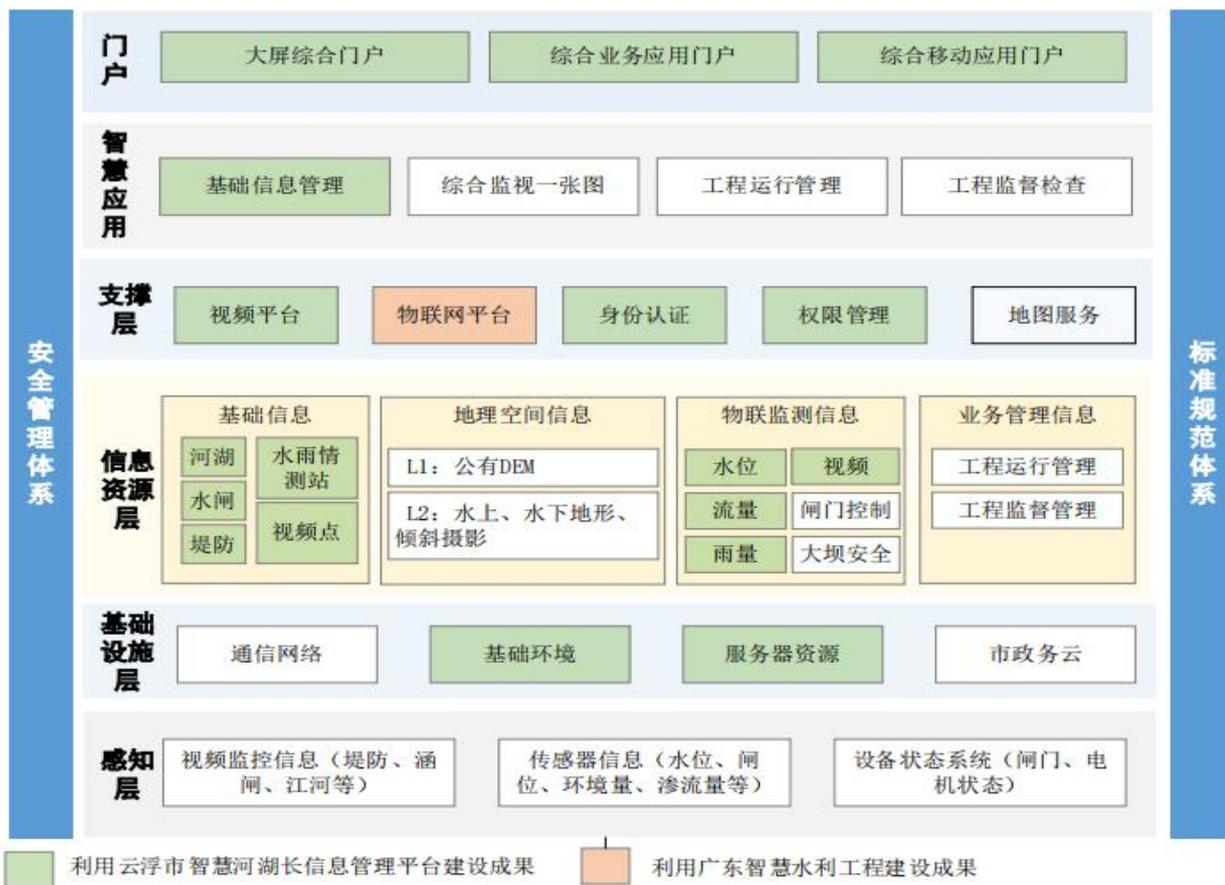
图 4.1-1 西江干流治理工程(云浮段)“智慧水利”建设总体设计架构示意图
