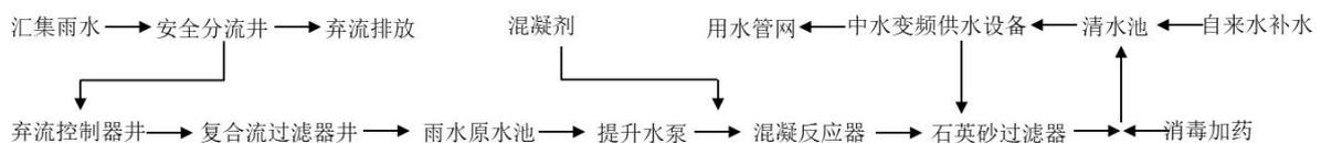
4、回用水系统不分区，在雨水处理机房内设置一套恒压变频给水设备直接供水至各用水点。
