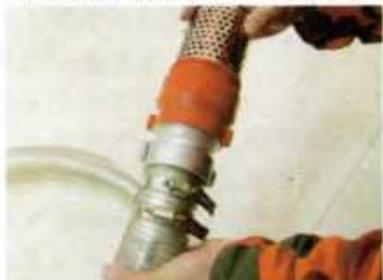
E. 检查吸水管，确保里面无杂质
