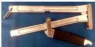
水带连接、维修和地形坡度大时停机止水工具。
