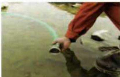
F.1 把吸水管放到水中灌满水，可减轻引水泵的工作量。如果不方便，也可直接用引水泵吸上水。
