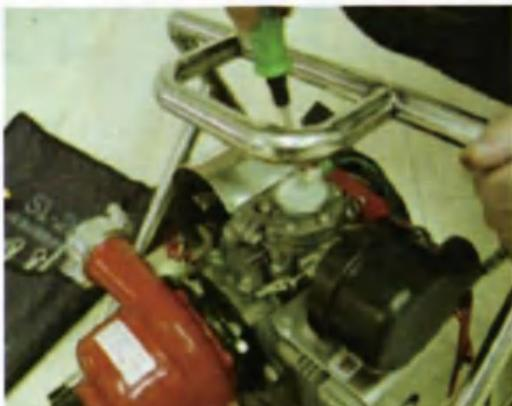
(3) 启动器的保养：如果启动器的起动绳过松要进行修理。首先卸下启动器的四个螺丝，检查各部件是否有松动。将起动绳在启动盘上绕紧后装到发动机上。
