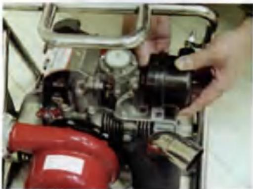
(2) 化油器的保养：用螺丝刀卸下化油器顶盖，清洗化油器网。
